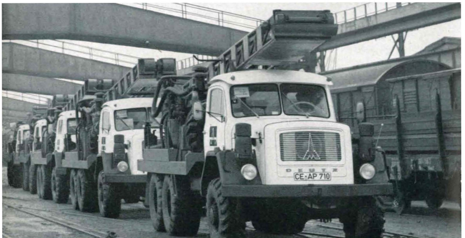
Kolonie der schwersten GÖTTKER-Bohrgeräte vom Typ M 500 auf Magirus-Fahrgestell vor der Verladung
