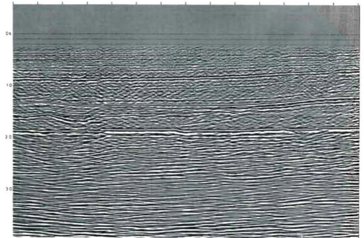
Fig. 5 Migration mit einer Apertur von \pm 80 Spuren
