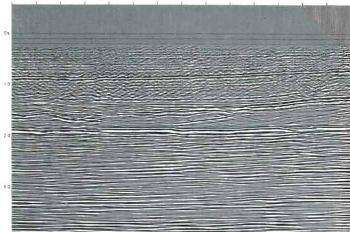
Fig. 4 Migration mit einer Apertur von \pm 40 Spuren
