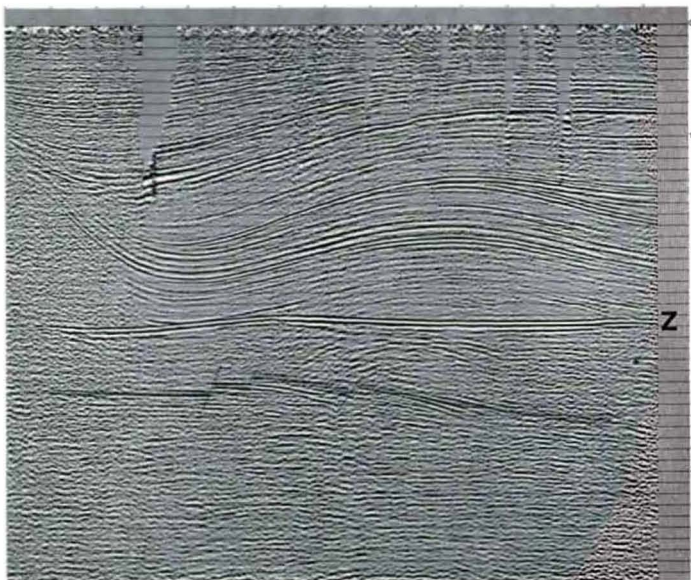
Fig. 10 Mittels neuester Techniken erzielter Präpermhorizont unter der Zechsteinbasis (Z), links ohne – rechts mit Migration dargestellt
