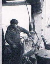
Fast 3 km lang ist das Meßkabel, das die „Explora“ beim Forschungseinatz hinter sich herzieht. Hier wird das aufgetrennte Kabel überprüft.
