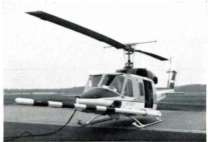
Neu konstruierter Helicopter-Stachel, der den Magnetometersensor trägt, mit dem erstmalig in einem Hubschrauber die Kompensation des magnetischen Flugzeugstörfeldes auf 1 nT (ein Milliardstel Tesla-Einheit der magnetischen Induktion) gelang
