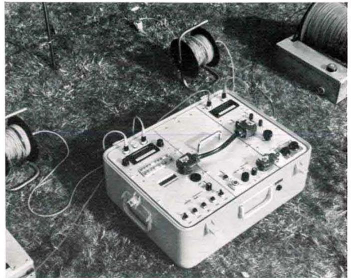
Geoelektrische Digital-Apparatur „ELAD“
