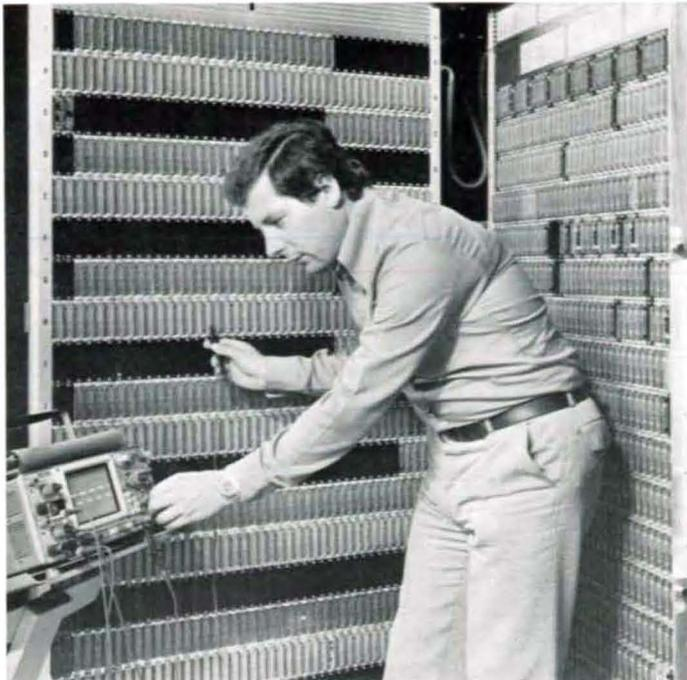
CD Service Ing. Weger bei der Prüfung eines Cyber Speicher-Chassis.
