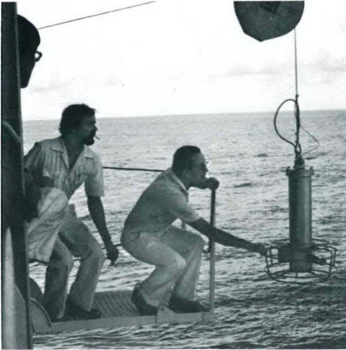
Labortechniker Homann und Servicetechniker Leitner beim Absenken eines Sensors für Temperatur, Salinität, Druck und Schallgeschwindigkeit auf 5000 Meter Tiefe
