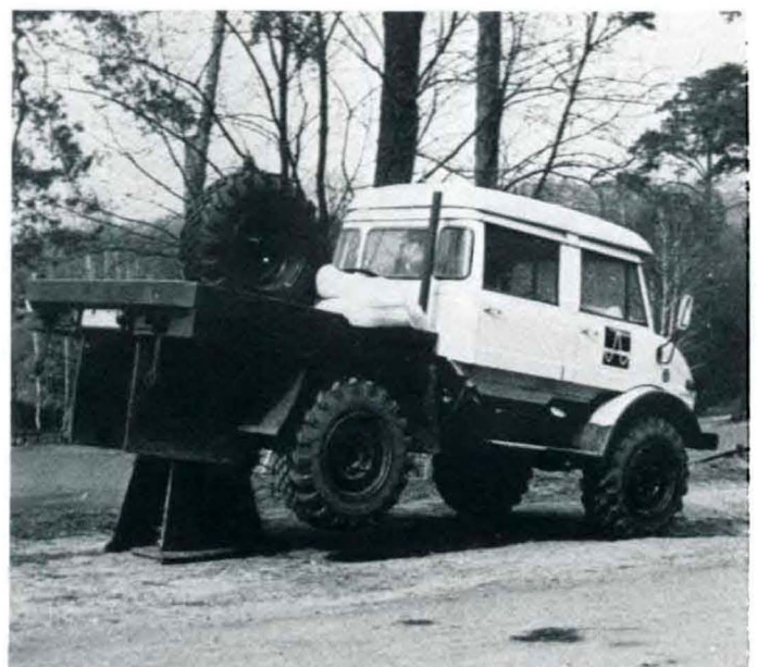
Abb. 6 Hammer mit Schallschluckvorrichtung bei Einsatz in Berlin Hammer with sound insulation working in Berlin
