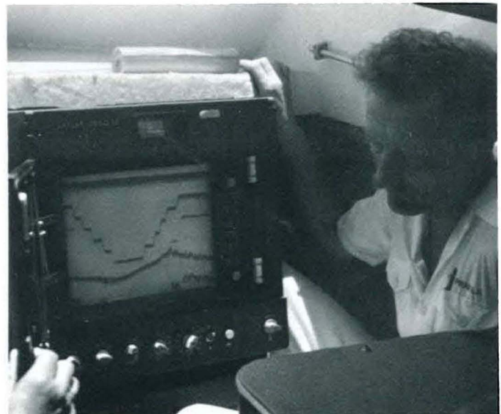
Labortechniker Kellermann bei der Kalibrierung der Echolote auf einem Vermessungsboot
