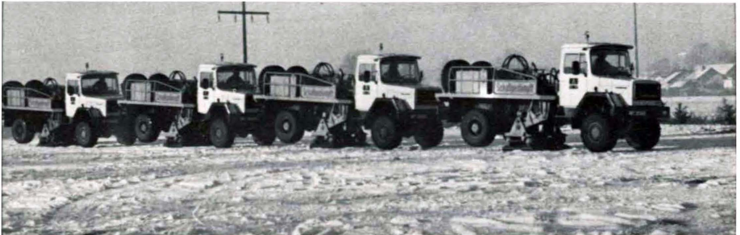
VVDA-Vierergruppe im Wintereinsatz Four VVDA-Vibrators in winter-operation
