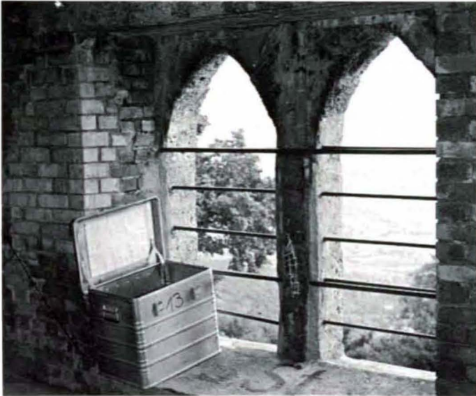
Abb. 3 Relais-Station für die Überbrückung der großen Schußpunkt-Geophonentfernungen Relay station, necessary for large shotpoint-geophone distances
