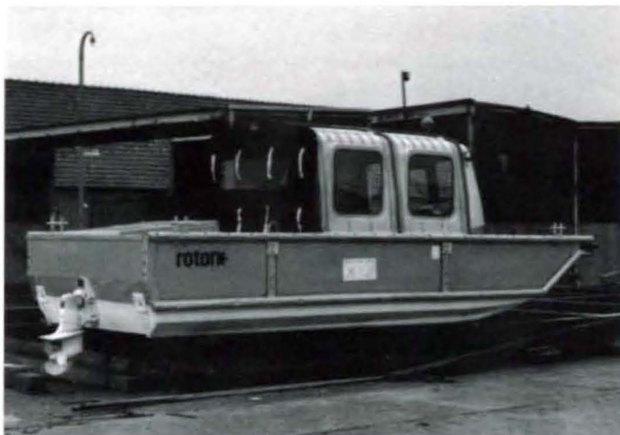
Die beiden Schottel-Navigator-Ruderpropeller The two Schottel-navigator steering props
