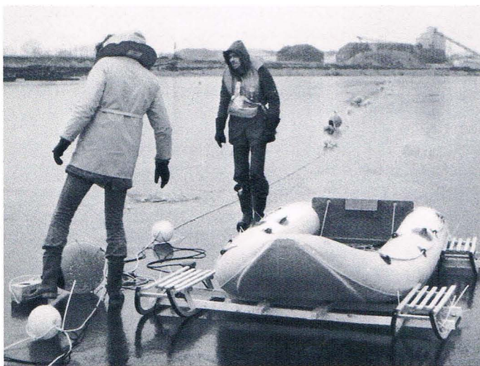
Geophonauslage über einem zugefrorenen Baggersee. Transportvehikel und Markierungsbojen Geophone layout crossing a gravel lake. Transport vehicle and marker buoys
