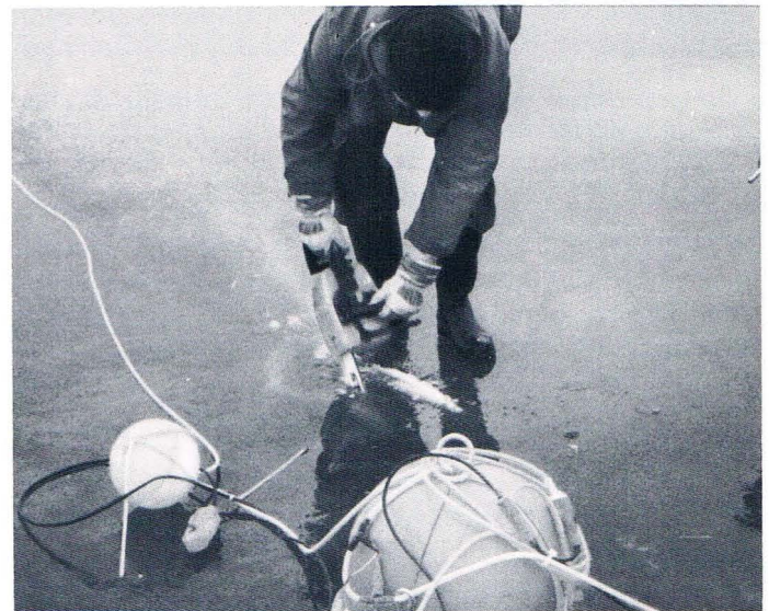
Zur Einbringung von Hydrophonen bw. Geophonen werden mit Baumsägen Löcher in das Eis geschnitten For lowering hydrophones or geophones into the water, holes are cut into the ice by chain-saws
