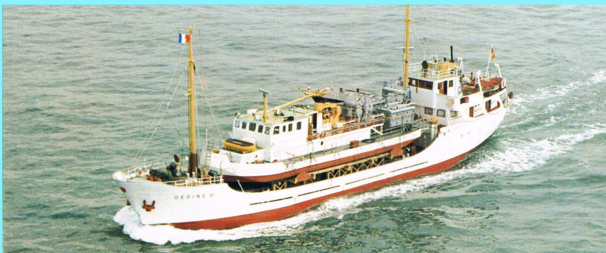
Flachwassermessschiff, von seinem Mutterschiff 'huckepack' ins Meßge- biet gebracht Shallow-water survey vessel carried 'piggy- back' to the survey area by her mother ship
