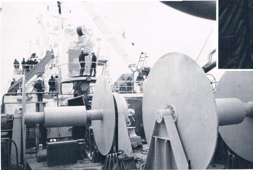
Winden für das Pelagische Netz (links) und das Grundschieppnetz (rechts) Winches for pelagic trawl (left) and the bottom trawl (right)
