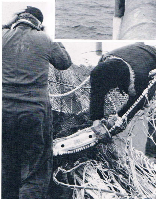
Befestigung einer Sonde am Pelagischen Netz Fastening a transceiver to the pelagic trawl
