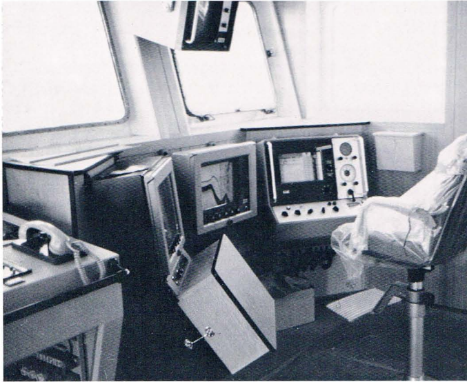
◀ Anzeigergerät für den Fischfang auf dem Brückendeck der ARC MALPELO (von links: Fischlupe, Echograph und Super-Lodar) Indicators for the fishery on the bridge deck of ARC MALPELO (from left: fish-lupe, echograph and super-lodar)
