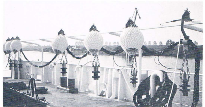
Luftpulser Array der ARC PROVIDENCIA Airgun array of ARC PROVIDENCIA
