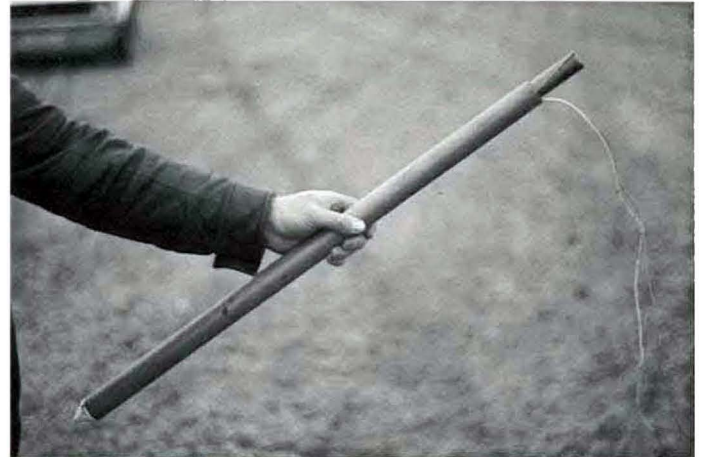
Sprengstoff im PVC-Rohr mit Plastikspitze Explosive in a PVC-tube with plastic cap
