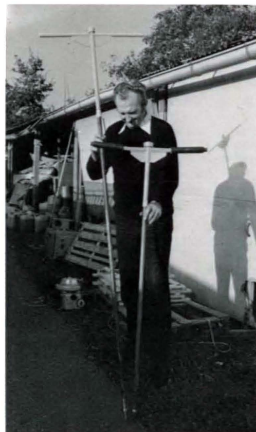
Handbohrlanzen (1,5 und 2,5 m) Hand lances (1.5 and 2.5 m)
