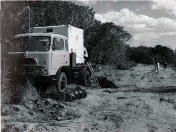
Der selbstgestrickte Meßwagen. Die tragbare Bangladesh-Apparatur wurde in eine für den Hubschrauber- einsatz verwendete Kabine installiert und auf einen gecharterten FIAT-LKW montiert.
