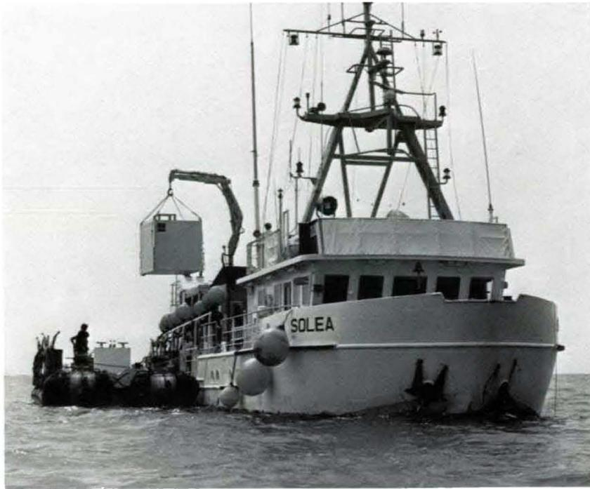
*Ein Vorgriff. Die seismische Apparatur befindet sich fest installiert in einem Container und kann für Messungen in extrem flachem Wasser auf einen Ponton gesetzt werden. Das Foto zeigt diese Prozedur.*
