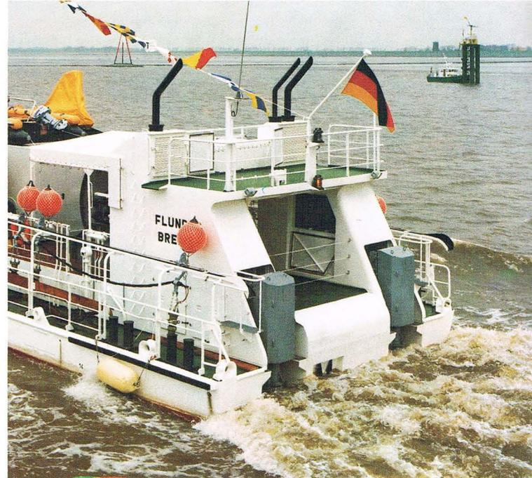
*Schottel-Antrieb und Auslaßöffnung für den Streamer*
