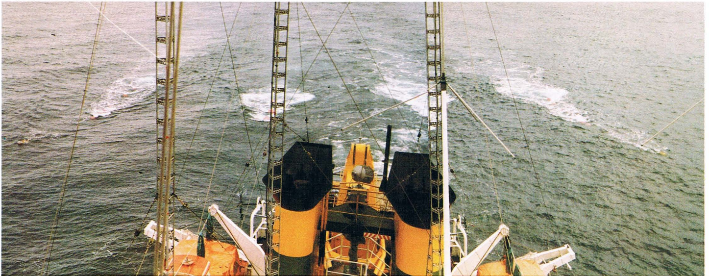
PROSPEKTA mit ausgestellten Flächen-Arrays in freiem Wasser PROSPEKTA towing wide-spread arrays in open water
