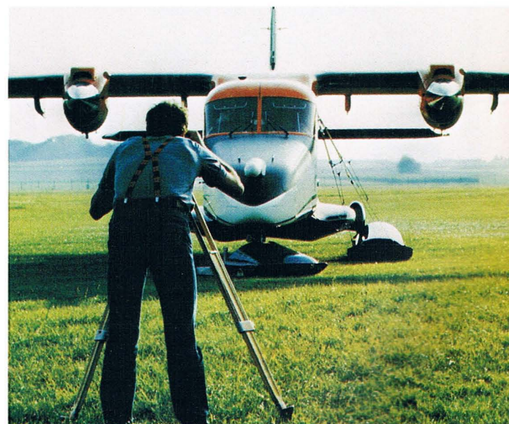
Training der feldmäßigen Eichung der Kompaßanlage mit einem Bussolentheodoliten
