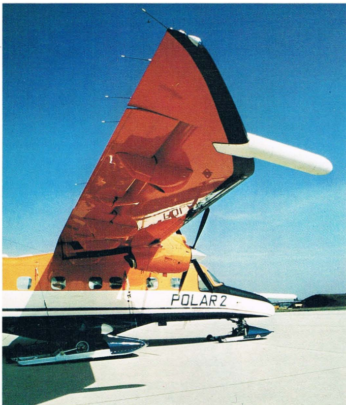
Der hochmoderne Flügel mit Sensor-Träger The modern wing with stinger
