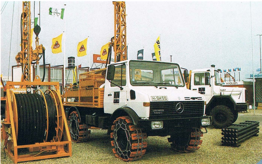
Eine elektrisch angetriebene Schlauchtrommel mit ca. 200 m Schlauch à 2", daneben die Bohrgeräte 3002 und RB 50 An electrically driven hose drum with c. 200 m hose (2") alongside the rigs 3002 and RB 50
