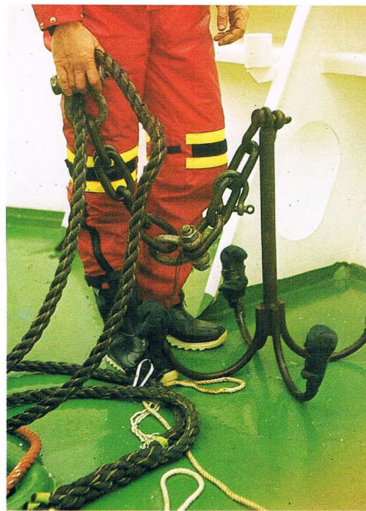
Der Anker der FLUNDER soll von Schiffen gekapptes Grundkabel wieder an die Oberfläche holen. Der Versuch mißlingt. The FLUNDER's anchor prepared for retrieving severed bay cable. The attempt fails.
