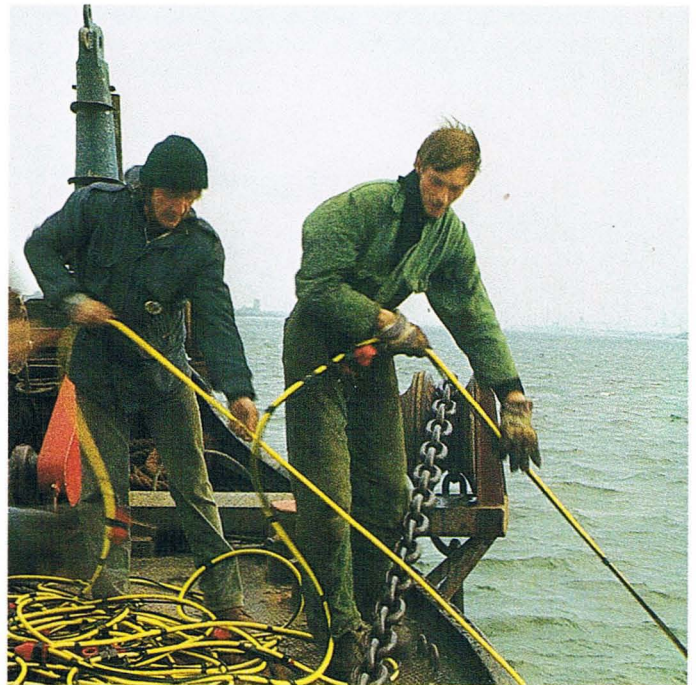
Der Anker der FLUNDER soll von Schiffen gekapptes Grundkabel wieder an die Oberfläche holen. Der Versuch mißlingt. The FLUNDER's anchor prepared for retrieving severed bay cable. The attempt fails.
