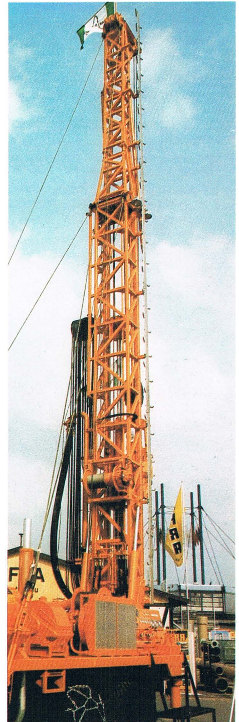
Der 17 m hohe Turm der Brunnenbohranlage RB 50 The 17 m mast of the well-drilling rig RB 50
