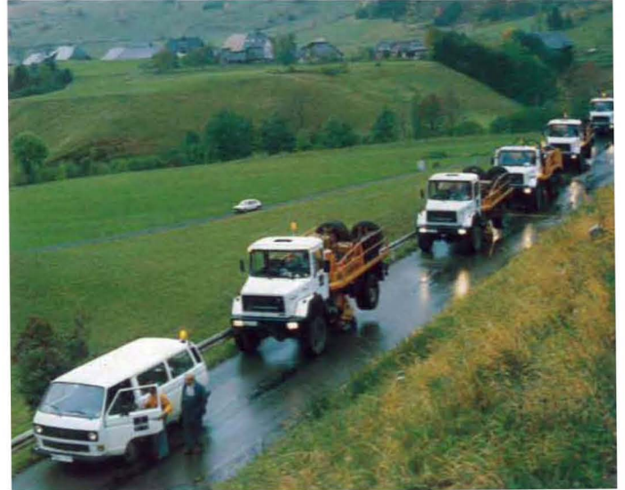
Fünf Vibratoren im Einsatz
