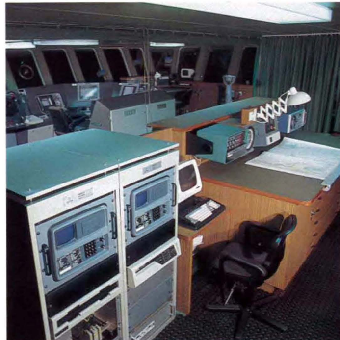
INDAS-V-Anlage mit Magnavox-Satellitenempfänger INDAS-V equipment with a Magnavox satellite receiver
