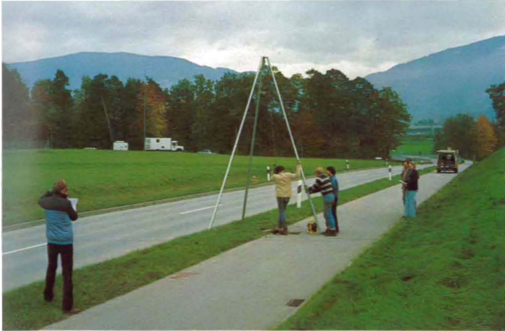
Nahlinienmessung mittels Dreibein und Fallgewicht, ausgeführt von Studenten der Universität Karlsruhe. Rechts der Meßwagen. (Links im Hintergrund: Aggregat und 'großer' Meßwagen.)
