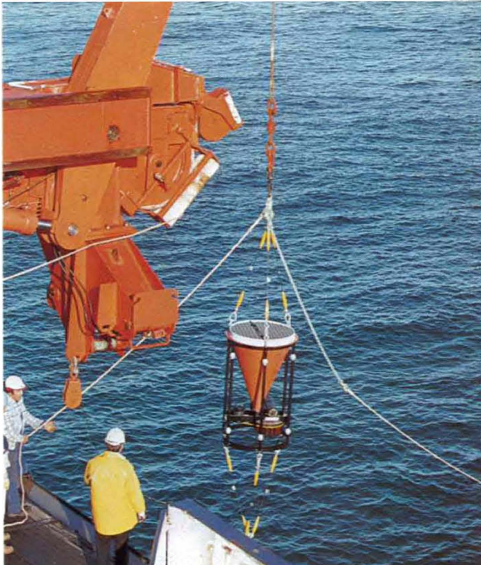
Eine Sedimentfalle wird auf den Meeresgrund abgesenkt (und etwa nach einem Jahr wieder geborgen, der Inhalt analysiert)
