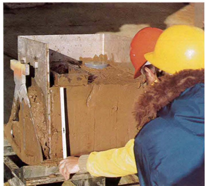
Der Kasteninhalt wird vermessen und analysiert. Es handelt sich um hellbraunen bis beige-oliv Schlick.
