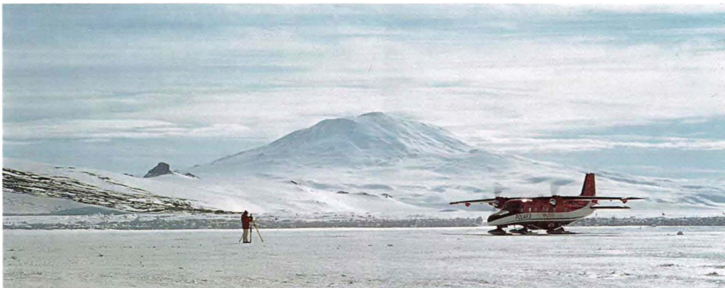
Kontrolle des Kreiselkompasses mit einem Bussolentheodoliten bei laufenden Motoren
