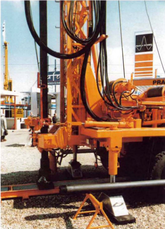
Fahrbare Brunnenbohranlage RB 30 mit Gestänge-Rutsche Mobile well-drilling unit RB 30 with drill-pipe slider
