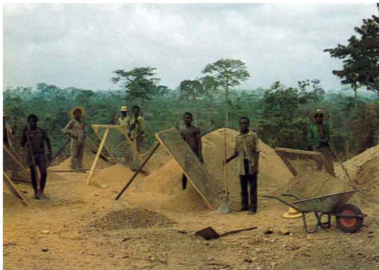
*Ursprünglich wurde der Kies auf diese etwas archaische Methode nach unterschiedlichen Größen ausgesiebt. Base-Camp Aboaso*
