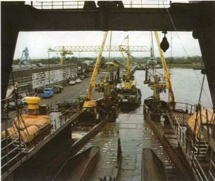
◁ *Achterschiff mit den beiden Netzbahnen von der Brücke aus gesehen*
