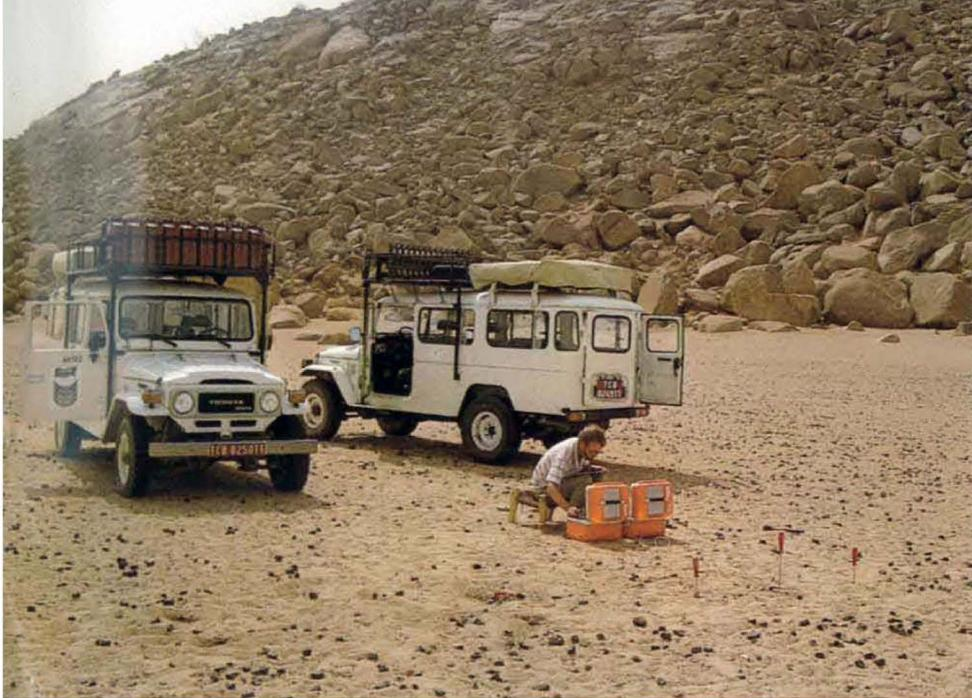
*Die Geoelektrik hilft bei der Erfassung wasserführender Schichten. Hier H.-G. Bufe (PREUSSAG) bei Gleichstromsondierungen, Abéché/Tschad*
