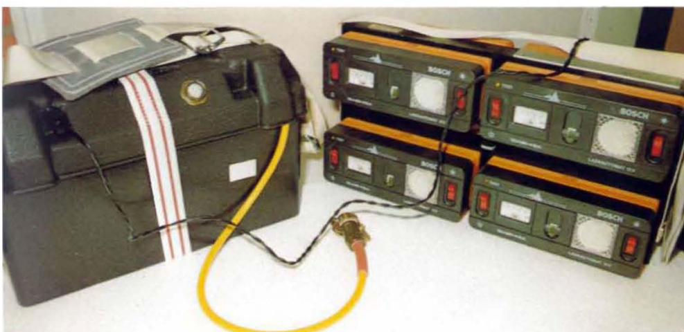
**Links: tragbare Power-Station. Sie enthält eine Batterie und einen Converter.**
