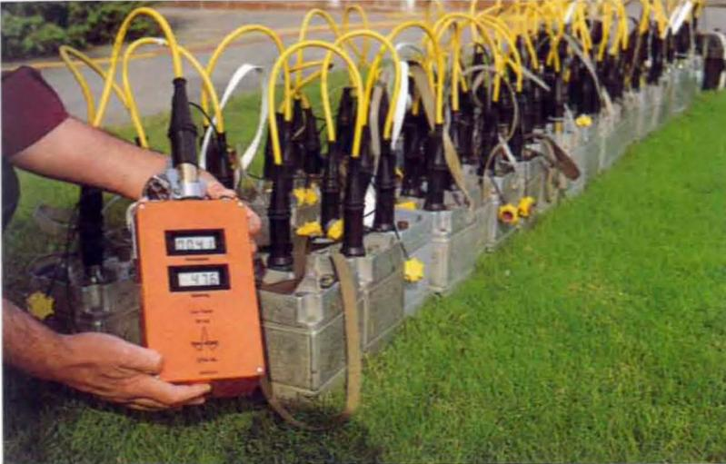
**Line-Tester und Telemetrieboxen**
