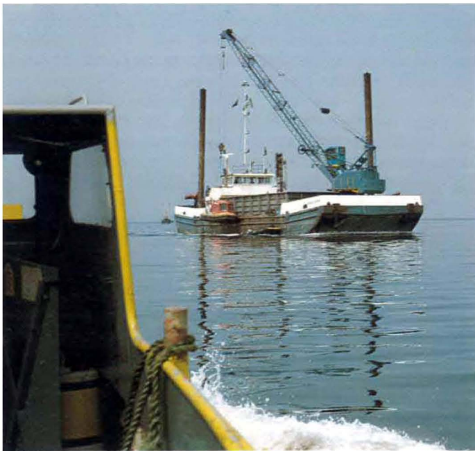
Bohrponton JOHANNA-JOSEPHINE zum Niederbringen von Aufzeitlöchern im Watt. In der Mitte er- kennbar der Turm einer unserer fahrbaren Bohranlagen vom Typ P 1002
