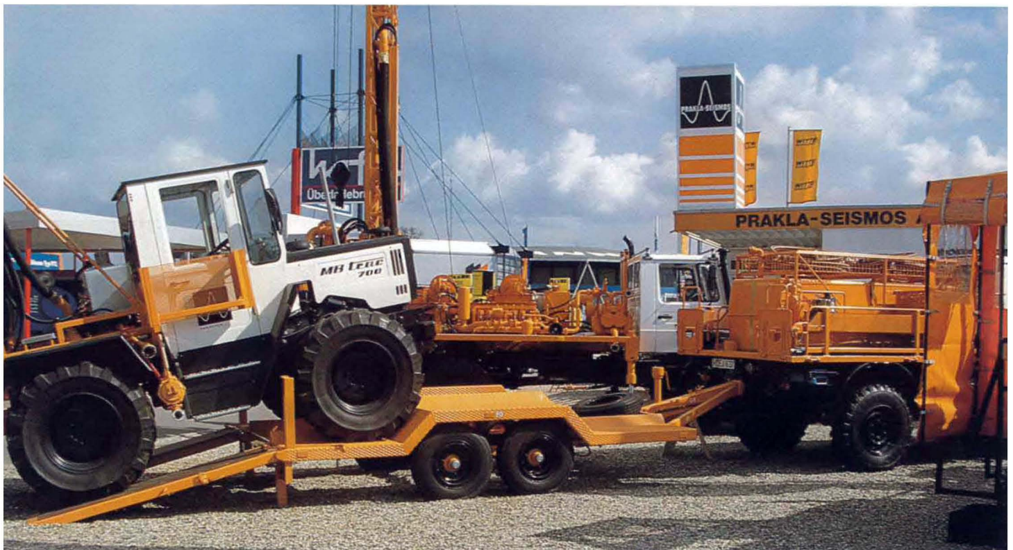
Bohranlage P 0501 auf MB-Trac mit Trailer und Wasserwagen Drilling rig P 0501 on MB-Trac with trailer and water truck
