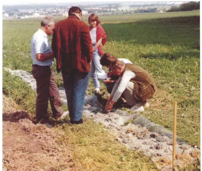
Analyse der Spülproben einer Aufzeitmessung. Nicht alle Gesteine sind grau.
