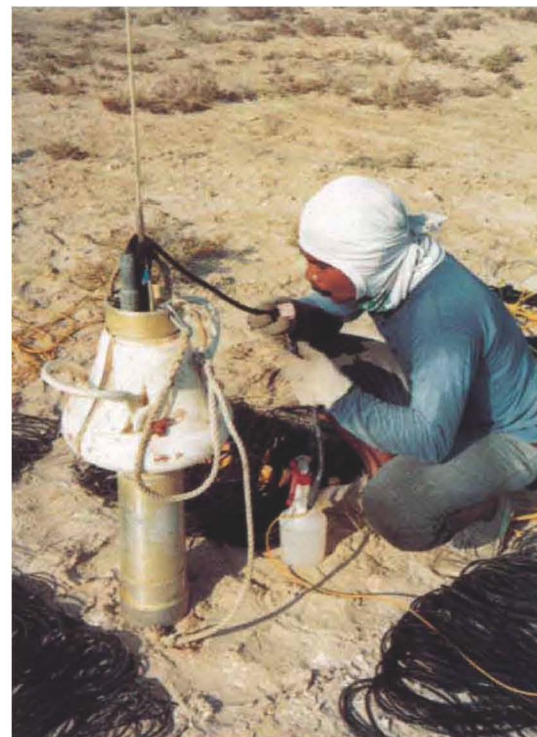
Eine MYRIASEIS-Boje onshore. Der Helfer, gut geschützt vor Sonneneinstrahlung, bläst den Staub aus dem Stecker, bevor er die Geophonketten anschließt. Dem Foto sind die eben gemessenen 47°C nicht anzumerken. A MYRIASEIS buoy onshore. The helper, with protective clothing against the sun, blows the dust out of the plug before connecting the geophone chains. The fact that the temperature is 47°C (120 F) can't be seen from the photo. ▽
