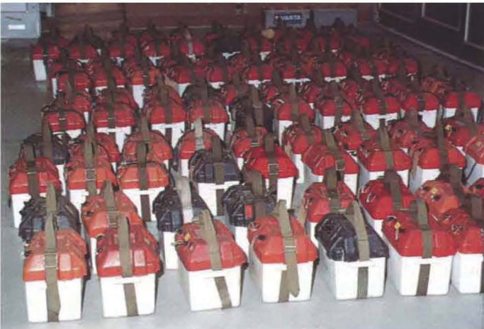
◁ Für einen 3D-Meßtrupp sind nicht weniger als 60 bis 80 Batterien bereitzustellen A 3D survey party requires no less than 60 to 80 batteries
