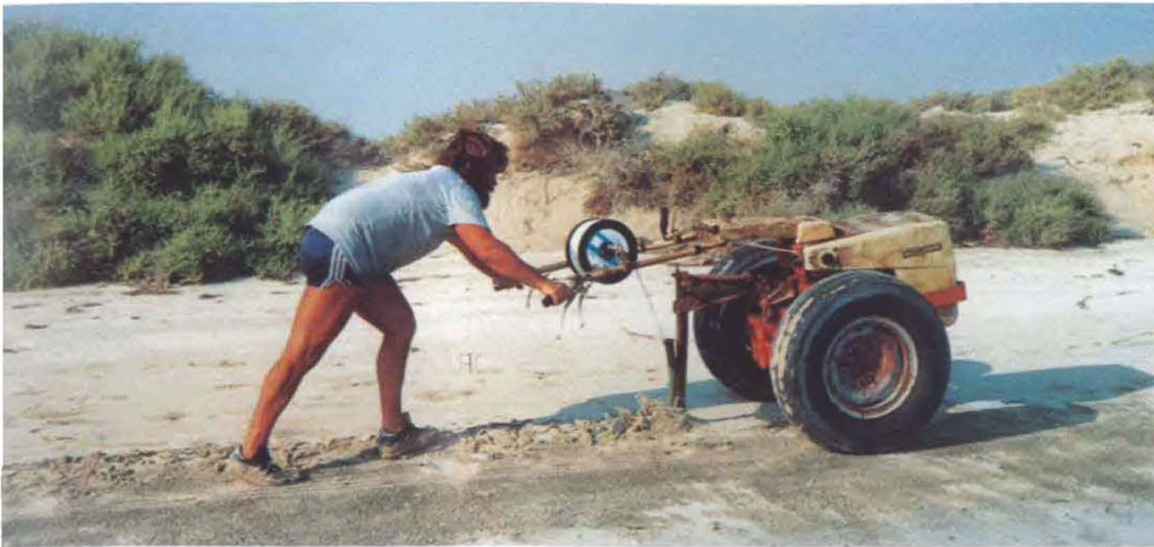
Eine MYRIASEIS-Boje onshore. Der Helfer, gut geschützt vor Sonneneinstrahlung, bläst den Staub aus dem Stecker, bevor er die Geophonketten anschließt. Dem Foto sind die eben gemessenen 47°C nicht anzumerken. A MYRIASEIS buoy onshore. The helper, with protective clothing against the sun, blows the dust out of the plug before connecting the geophone chains. The fact that the temperature is 47°C (120 F) can't be seen from the photo. ▽
