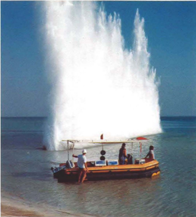
Detonation einer 50m langen, im Flachwasser ausgelegten Sprengschnur
