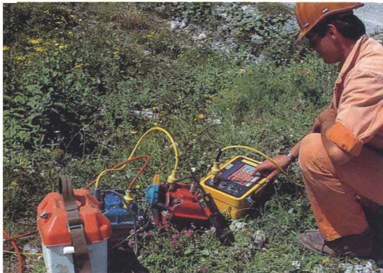
Telemetrie- und Power-Boxen. Der Line-Checker prüft, ob alle Meßkabel und Geophongruppen der bis zu 5 km langen Auslage korrekt angeschlossen sind.
