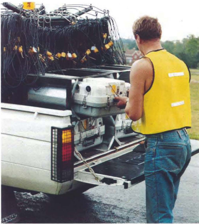
Auf dem Kabelwagen werden Kabel, Geophonketten und RSC-Boxen transportiert.
