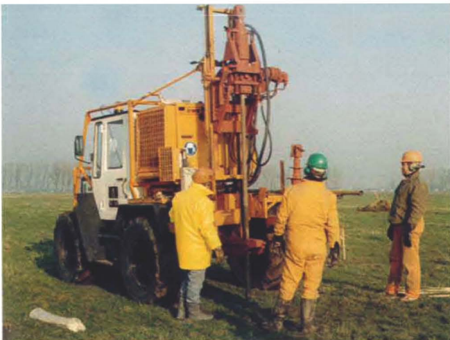
Schlaghammergeräte als Vertreter des neueren Verdrängungsbohrverfahrens mit pneumatischem Antrieb Rotary Bohranlage P 0501 (oben), mit hydraulischem Antrieb Rotary Bohranlage P 0152 (oben rechts) und mechanischem Antrieb Rammhammer RH 130 S Pionjär (rechts)
