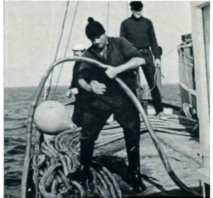
Der Streamer wurde anfangs von Hand vom Kümo ausgelegt
