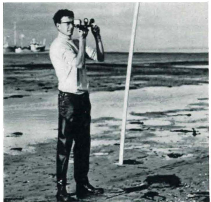
Einmessung mit Sextant und Meßstangen
