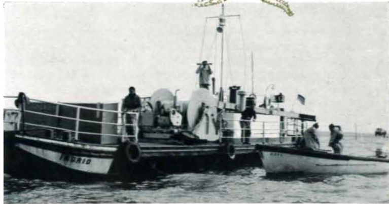
Meßschute „Ingrid“ mit Hilfsboot „Hedwig“; auf dem Vordeck U-Schienen zur Aufnahme des Unimogs im Hintergrund; Einmessung mit Entfernungsmesser. Bild 4
