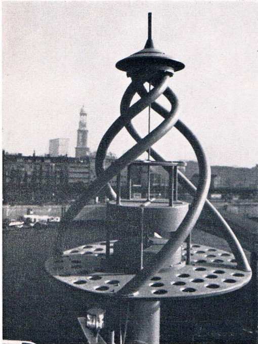
Antenne für die Navigationssatelliten.
